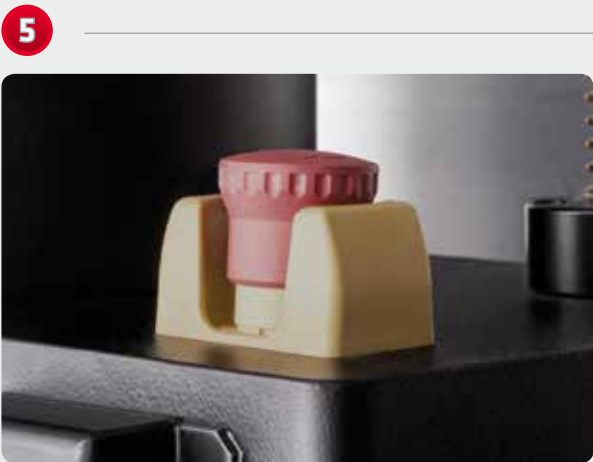
EMERGENCY STOP / NOTSCHALTER
